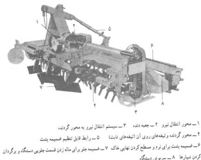
شکل 13- قطعات گاواهن دوار
