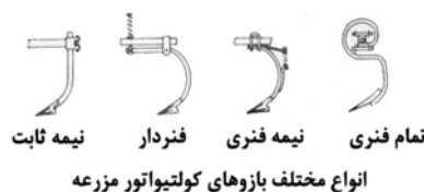
شکل 18- انواع مختلف بازوهای کولتیواتور مزرعه
