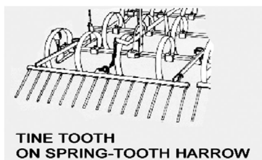
شکل 27- پنجه دندانانه فنری دارای ضمیمه پنجه دندانانه انگشتی
