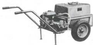
یک نوع سمپاش چرخدار موتوری با مخزنی از جنس فایبر گلاس.
