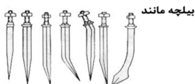
شکل 22- شکل های مختلف دندانه میخی
